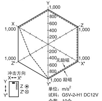
测定: 在无励磁、励磁状态下, 往3轴6方向上各加3次冲击, 测出触点产生误动作的值。
